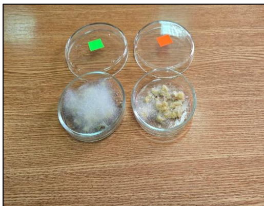
Рис. 4. Чашки Петри с плесенью, обработанные католитом и анолитом
